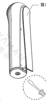
2 拆出下壳4处螺钉,将上壳和下壳分开,并将连接线和连接器拆下。
